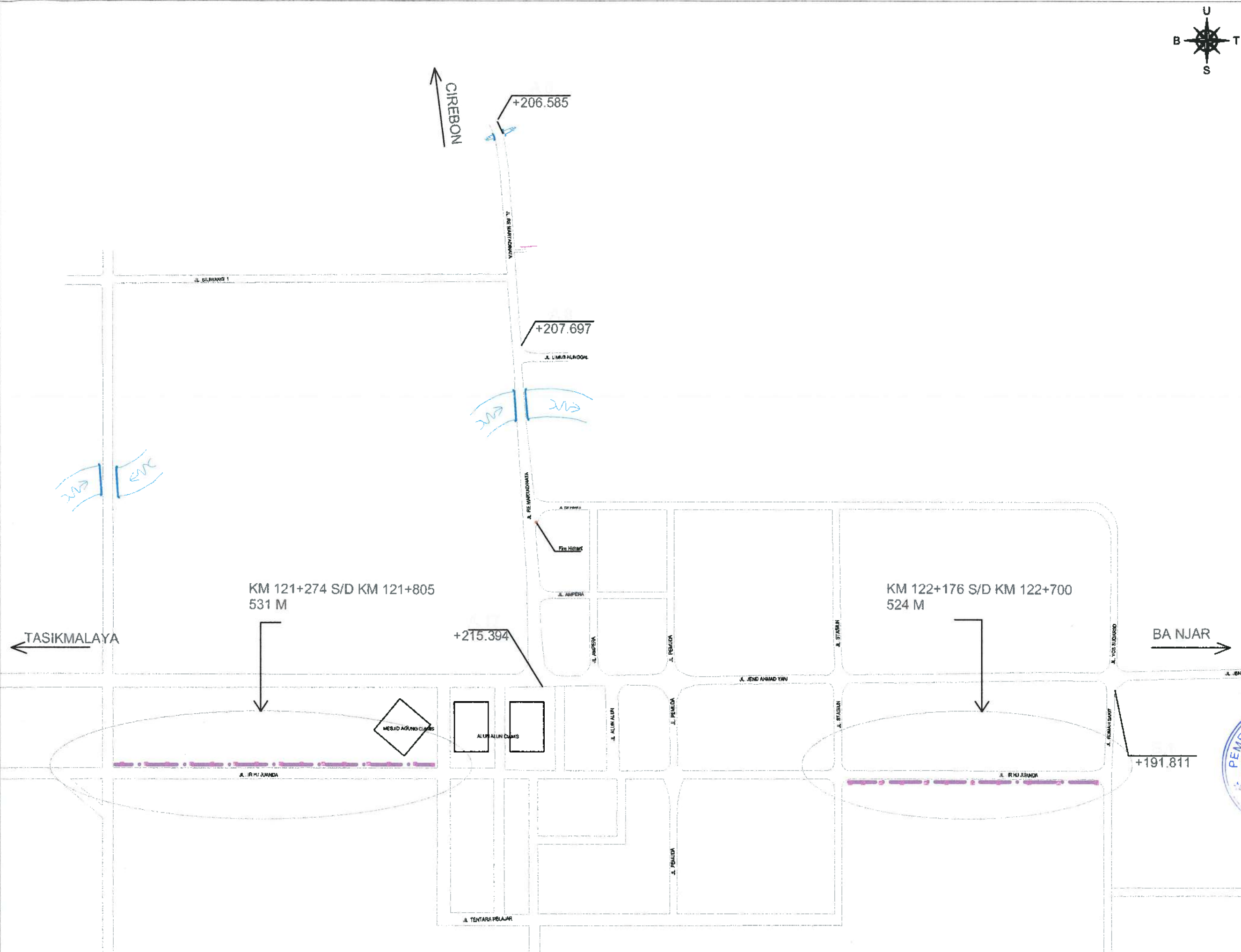
SITE PLAN RENCANA PEKERJAAN PEMASANGAN PIPA PADA BAHU JALAN NASIONAL JL INSINYUR H JUANDA KM 121+274 S/D KM 121+805 & KM 122+176 S/D KM 122+700
